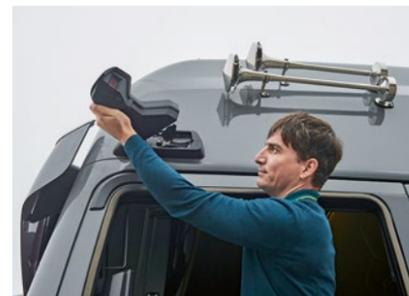
Die Haltearme sind in zwei Richtungen klappbar
