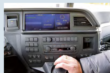
Auch im E-MAN macht der Dreh-Drück-Steller „Smart-Selection“ berührungsempfindliche Bildschirme überflüssig
