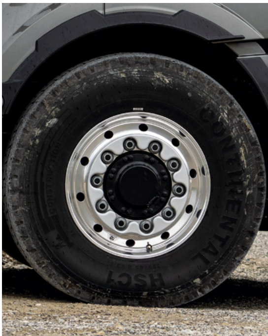
Vorderachse mit hydrostatischen Radnabenmotoren.
