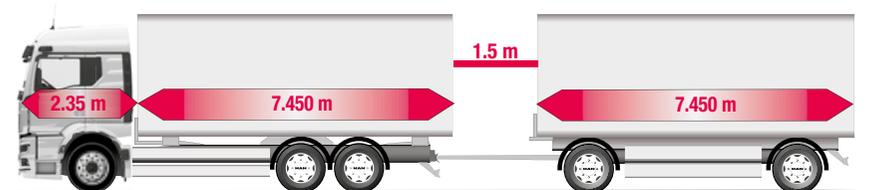
Ableitbare Maße bei Drehschemelanhänger mit Gesamtladelage 14,90 m.
