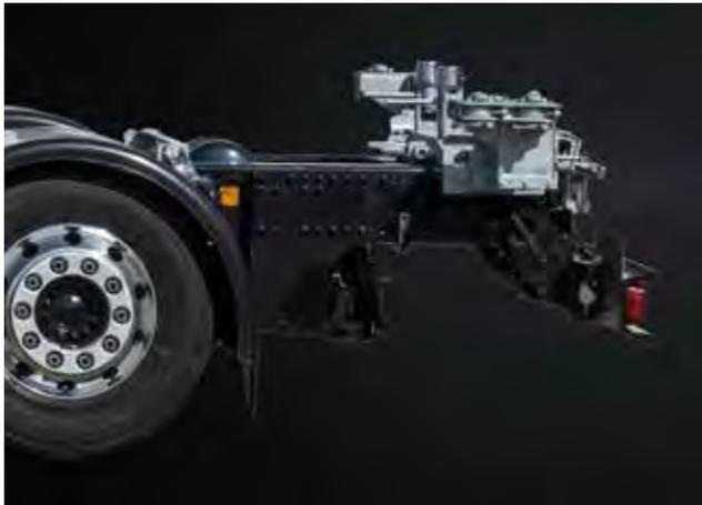
Klappbarer Unterfahrschutz mit einfachster Bedienung durch Hebel rechts und links in Verbindung mit Tief-Anhängerkupplung.
