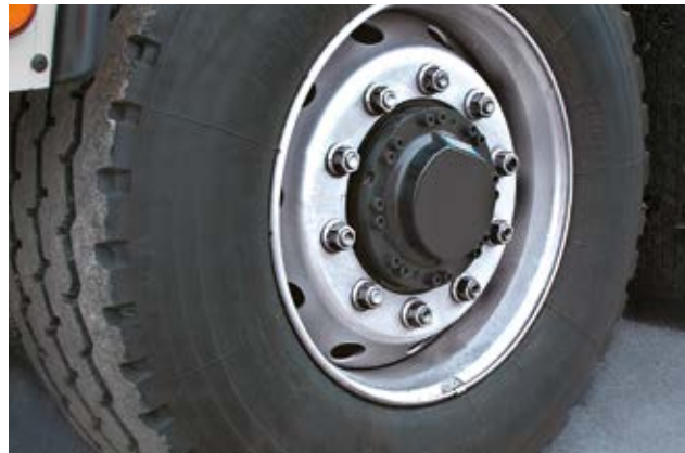
Vorderachse mit hydrostatischen Radnabenmotoren
