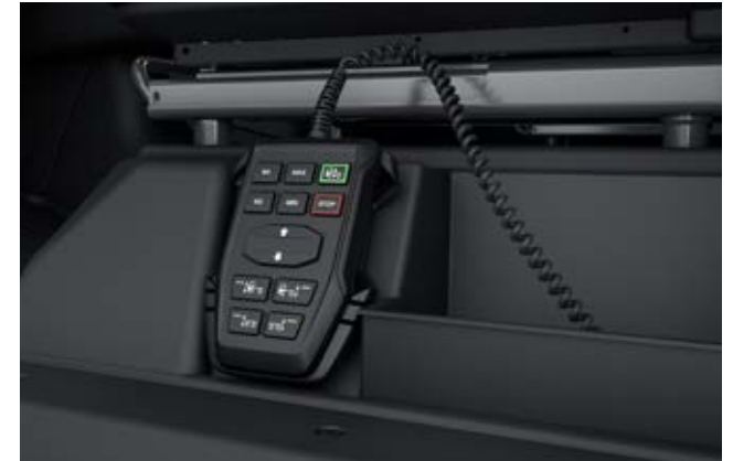
Bedieneinheit für elektronisch geregelte Luftfederung (VASC)
