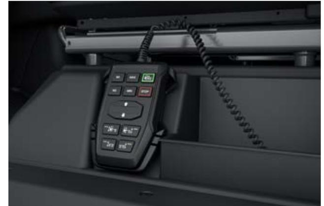
Bedieneinheit für elektronisch geregelte Luftfederung (VASC)
